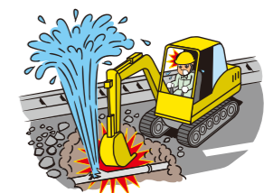
工事場内でガス管の埋設工事の際、バックホーの操作を誤り、地中の水道管を破損してしまった。
